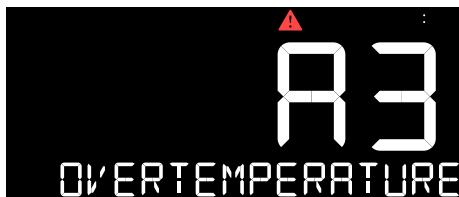
Fig. 40: Ejemplo: alarma de exceso de temperatura activa A3
