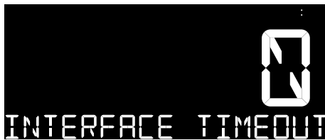
Fig. 30: Supervisión de la conexión desactivada
